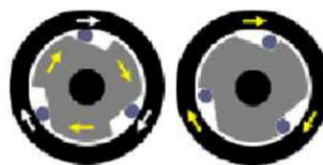
Princip rada jednosmerne spojnice sa uklinjavajućim valjcima
