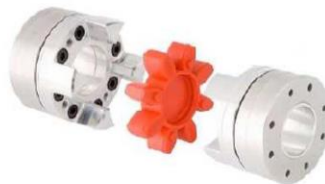
Kandžasta spojnica sa poliuretanskim umetkom u obliku zvezde proizvođača KTR
