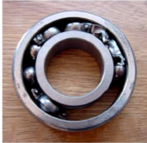
Drobljenje i topljenje kotrljajnih elemenata ležaja
