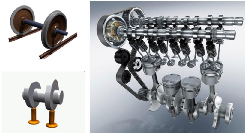
Bregasta osovina (gore) i kolenasto vratilo (dole) motora automobila
